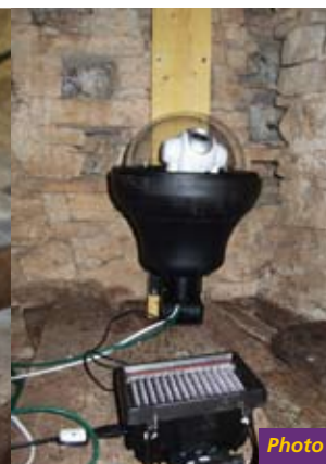
Photo 12 : Projecteurs infrarouge de 140 leds de 3 mm (produit très répandu).
