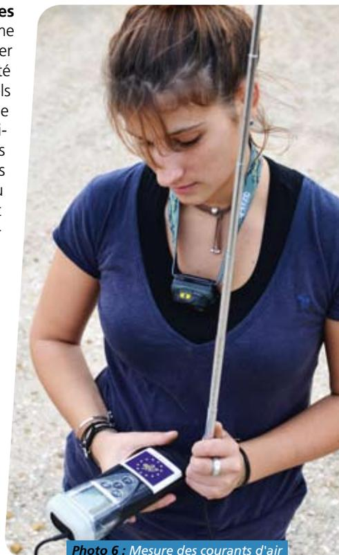
Photo 6 : Mesure des courants d'air avec un anémomètre.
