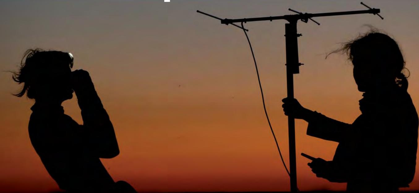
**Télémétrie** : mesure de l'azimut en fonction de l'axe de l'antenne. © Tanguy Stecklé
